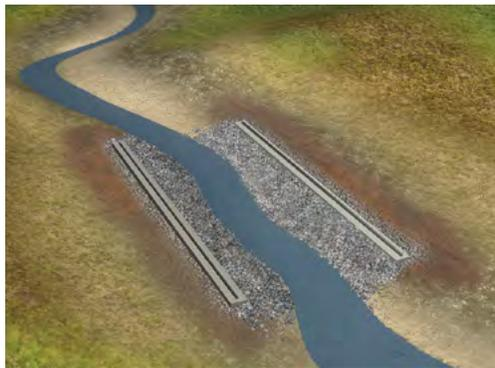
Las cimentaciones de concreto reforzado son vaciadas sobre una superficie preparada.
