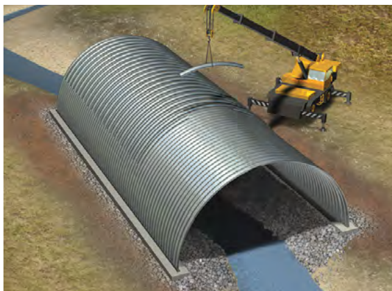
Si se necesita, se pueden agregar costillas de refuerzo.
