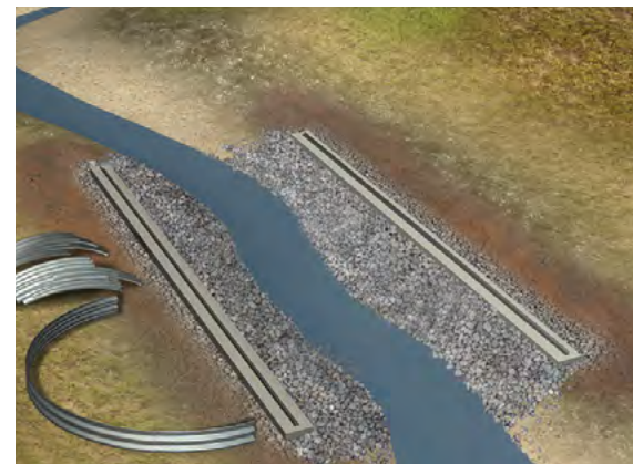
El primer segmento de arco se ensambla completamente en el suelo.
