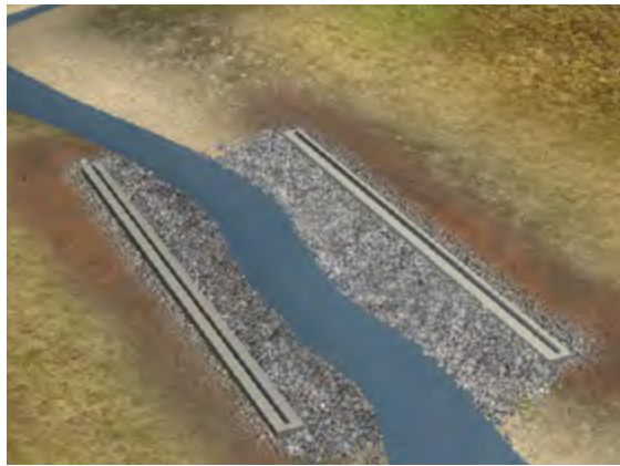
Las cimentaciones de hormigón armado son ejecutadas sobre una superficie preparada.
