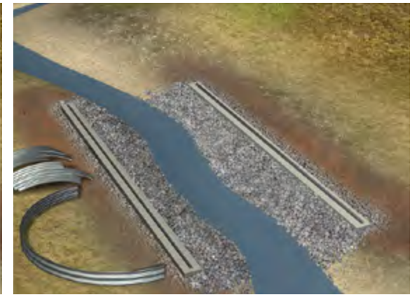
El primer segmento de arco se ensambla completamente en el suelo.
