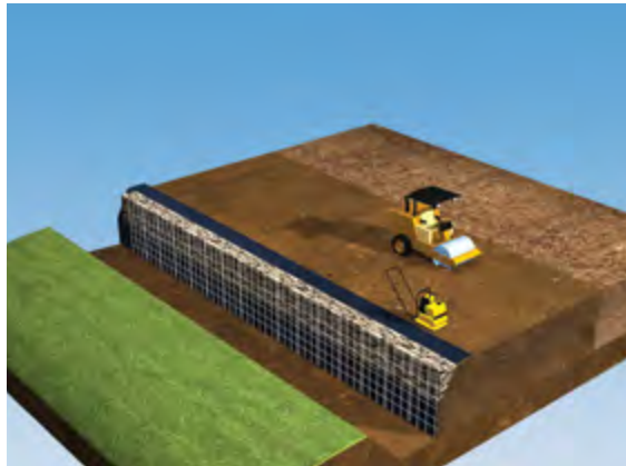
Se coloca el primer nivel de material compactado con geotextil y piedra seleccionada.
